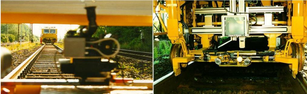
*Laserstrahl (fix) am Sat zielt auf PSD (Position Sensitive Device) am EM-Sat; die PSD (Position Sensitive Device) misst die Pfeilhöhen bei Bewegung des EM-Sat*
