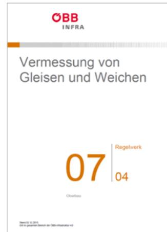
Das Regelwerk 07.04 wurde gemeinsam mit dem Oberbau erstellt und enthält Vorgaben sowohl für die geodätische Vermessung von Gleisen und Weichen als auch für alle relativen Messverfahren. Das Regelwerk 17.02 ist derzeit im Aufbau begriffen und soll alle Messmethoden beinhalten inklusive GIS-Vorgaben.
