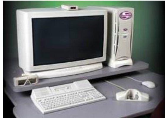
Digitales Auswertegerät ImageStation ZII (Intergraph)
