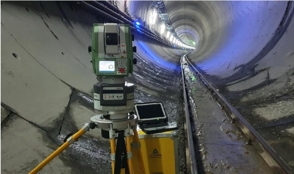
**Abb. 10:** GYROMAT 5000 mit vollständig automatisierten und überwachten Messablauf (eigene Darstellung)
