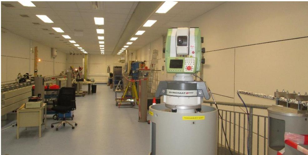
**Abb. 8:** Kreiselkalibrierung im Messlabor der Technischen Universität Graz (eigene Darstellung)
